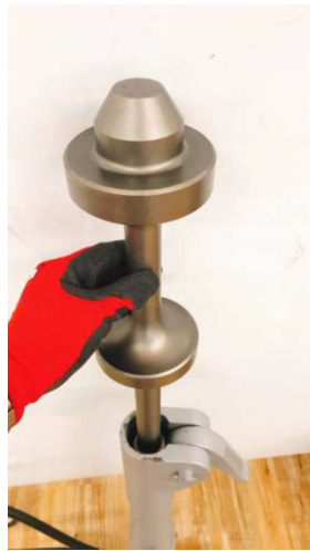
杭打撃治具の挿入
