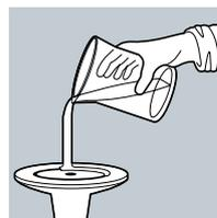
4.ガードコーンの接着面にある溝部にも、接着剤が溝からあふれ出るまで流し込みます。
