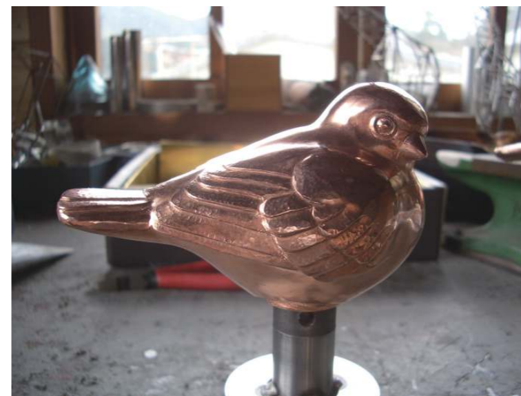
左上：銅の原型 金型のための「見切り線」がペン描きされています。
